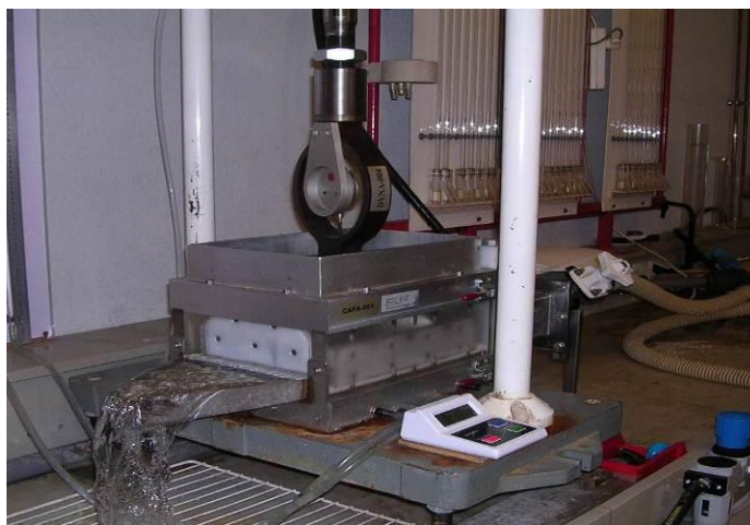
Figure 3. Banc d'essai pour la détermination de la capacité de débit dans le plan.
